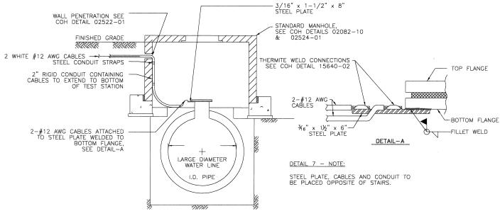
ABOVE GROUND CROSSING FLUSH MOUNTED FLANGE ISOLATION AND ANODE INSTALLATION TEST STATION
